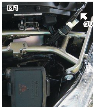
図1 グリップヒーターコネクタから電源を取ります。
