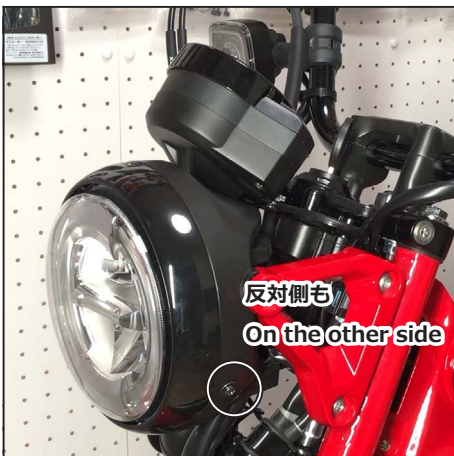
スクリー2本を外し、コネクタを抜きながらヘッドライトを外します。 Remove 2x Screws [A] and remove headlight.
