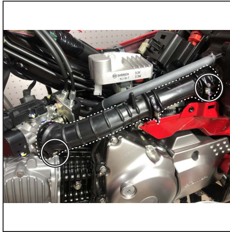
スクリー2本を緩めて、コネクティングチューブを外します。 Loosen 2x screws and remove connecting tube.
