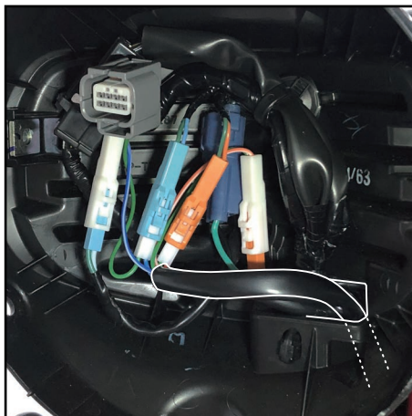
②メインコードの6Pカプラー側をライトケース内側から配線用の穴に通し、外に出します。 ②メインコードの青コード側を右ウインカー用のカプラー（水色）に、橙コード側を左ウインカー用のカプラー（橙色）にそれぞれ割り込ませます。 Pass ② Main wire through wiring hole in headlight case. Insert blue wire side of ② main wire into coupler for R-turn signal (light blue) and orange wire side into coupler for L-turn signal (orange).
