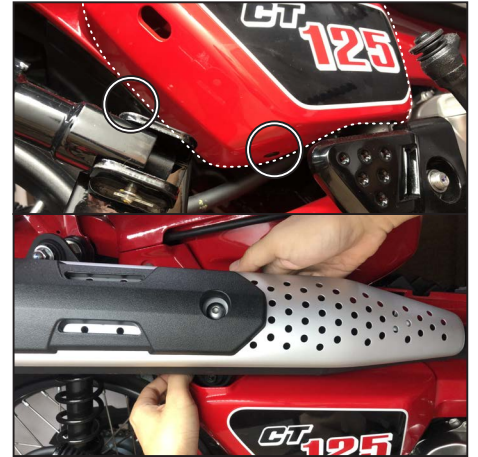
スクリー1本と、トリムクリップ（長）1本を外し、右ボディカバーを外します。 ※後方から順にロックを外していきますが、新車時はずりも硬いです。カバーを外さず下の隙間から作業することも可能です。 Remove 1x screw and 1x trim clip (long) and remove right body cover.
