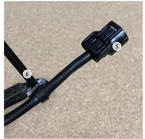
⑤センサーサブコードの大きなコネクターから40mmの位置に⑥クリップ付き結束バンドを取り付けます。
