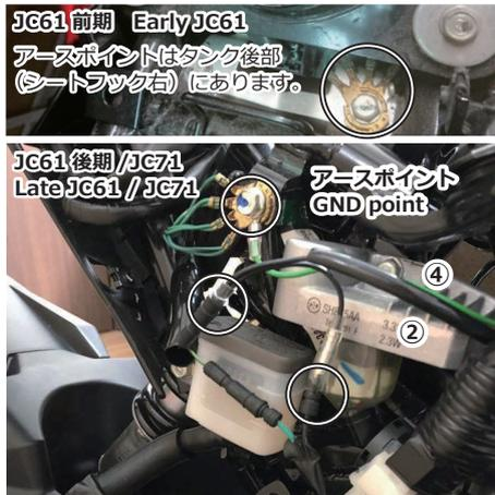
配線ブーツを上によらし②電源コードをリアブレーキスイッチの黒コードの接続端子間に割り込ませる。
