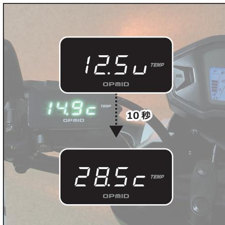
キーを回すと、まず電圧計を表示してから油温計に切り替わります。外気温に近い温度が表示されていることを確認します。
