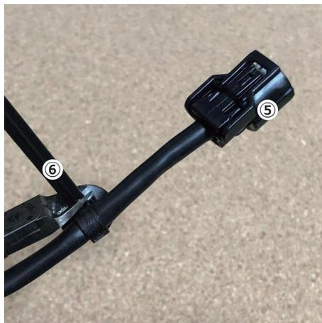
⑤センサーサブコードの大きなコネクターから40mmの位置に⑥クリップ付き結束バンドを取り付けます。 Attach ⑥Cable Ties w/Clip to 40mm position from ⑤Sensor sub wire's connector.
