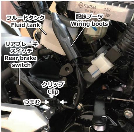
リアブレーキスイッチコードのクリップを外し、フルードタンクの裏から配線ブーツごと引っ張り出します。
