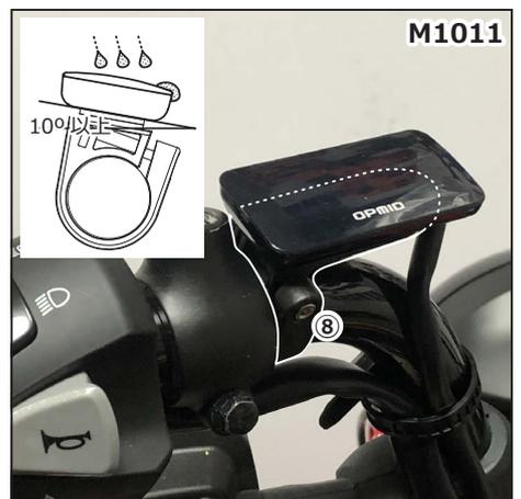
⑧ ハンドルバーブラケットをハンドルに通し、ネジを締め固定します。パネルに水がたまるのを防ぐために、水平より10度以上傾けて固定してください。
