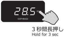
大雨など、多量の水濡れによる誤作動を防止するために本製品は常にスクリーンロックをかけています。3秒間タッチすることでロックを解除し、各種操作が可能になります。無操作で5分経過すると再びロックがかかります。To prevent malfunction caused by heavy rain, this product always keeps screen lock. Touch for 3 seconds to release the lock. It will be locked again after 5 minutes of no operation.
