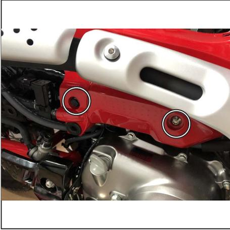
右メインパイプカバーのクランクケース上の2本のスクリューを外します。
