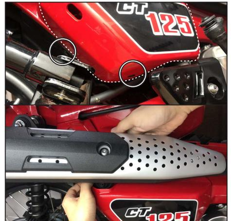
スクリー1本と、トリムクリップ（短）1本を外し、右ボディカバーを外します。
