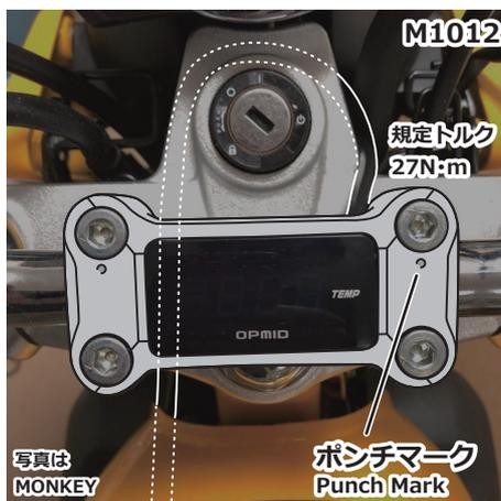
⑧ アッパーホルダーのポンチマークをフロント側に向け、純正キャップ 4 個、純正ソケットボルト 4 本を再利用して取り付ける。ポンチマーク側のボルトから締め付ける。キーシリンダーの前方にコードを回し、メインハーネスに沿わせる。
