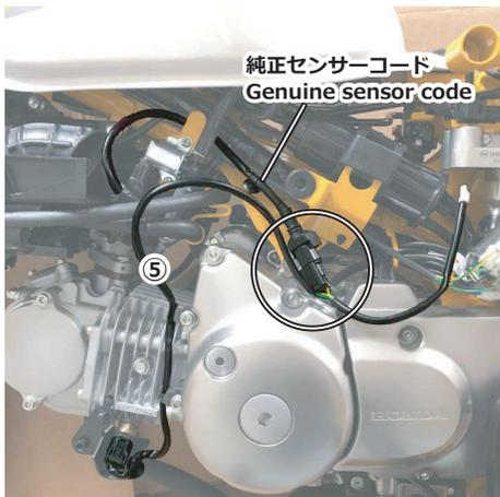
純正センサーコードと⑤センサーサブコードを接続します。
