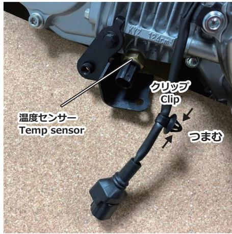
シリンダーの左下にある純正温度センサーのコネクターとクリップを外します。
