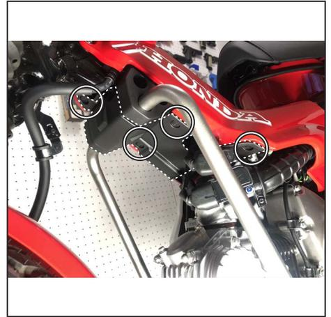
トリムクリップ（短）を4本外し、メインパイプロアカバーを外します。
