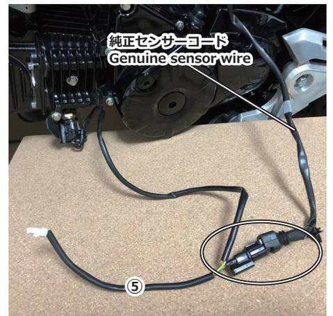
純正センサーコードと⑤センサーサブコードを接続します。
