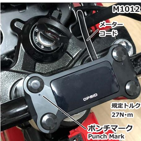
⑧ アッパーホルダーのポンチマークを前方に向け、純正ソケットボルト4本を再利用して取り付けます。ポンチマーク側のボルトから締め付けます。キーシリンダーの右側にあるブレーキスイッチコードのガイドにメーターのコードを通します。
