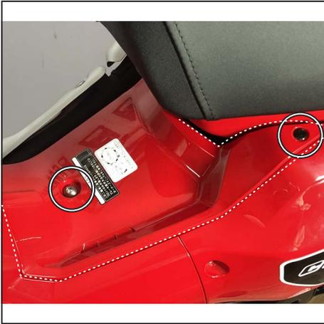
1本のスクリーとトリムクリップ（長）を外し、センターカバーを外します。
