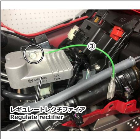
レギュレートレクチファイアの固定ボルトに③アースコート（150mm）を共締めします。
