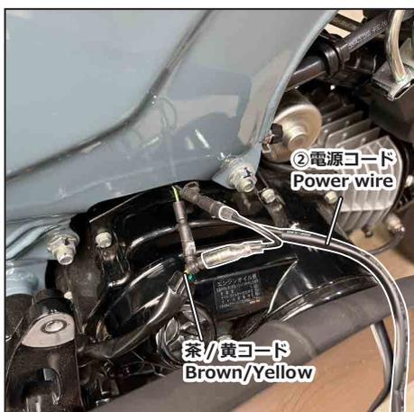
②電源コードをリアブレーキスイッチの接続端子間に割り込ませる。スイッチ側のコード色は茶/黄です。
