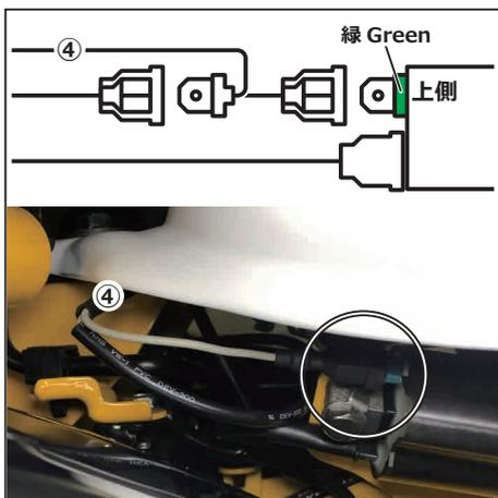
④IGコイル分岐コードをイグニッションコイルの上側のコネクターに割り込ませる。
