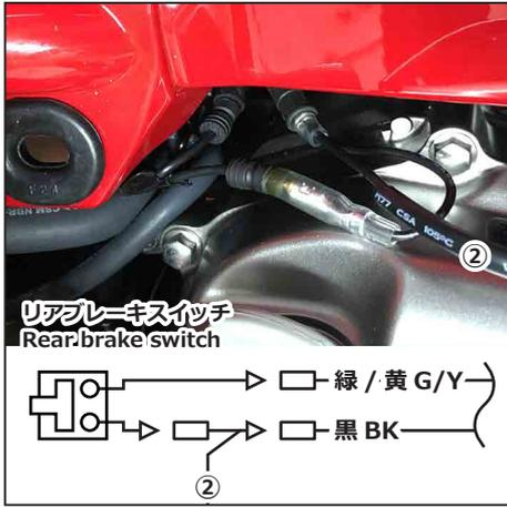
リアブレーキスイッチコードのプラス側（車体側コード色が黒）の間に②電源コードを割り込ませる。
