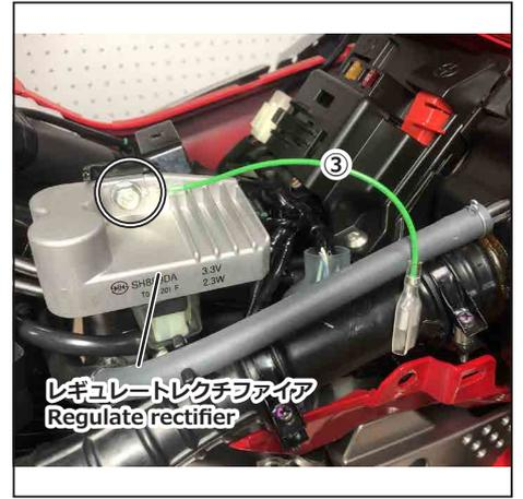
レギュレートレクチファイアの固定ボルトに③アースコードを共締めします。
