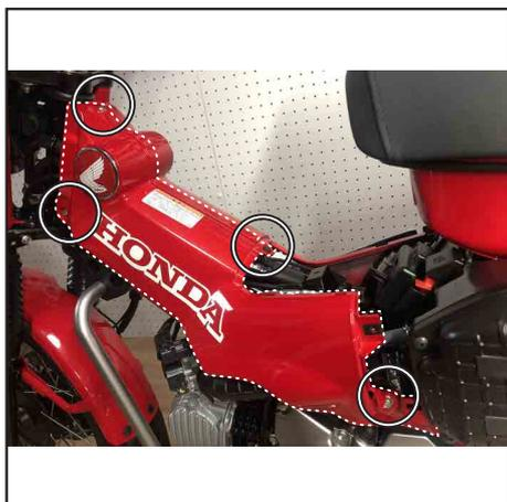
スクリー3本と、トリムクリップ（短）1本を外し、左メインパイプカバーを外します。
