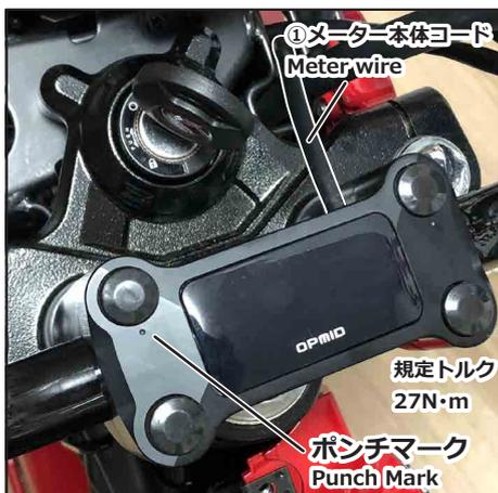
アッパーホルダーのポンチマークを前方に向け、純正ソケットボルト4本を再利用して取り付けます。
