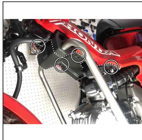
トリムクリップ（短）を4本外し、メインパイプロアカバーを外します。
