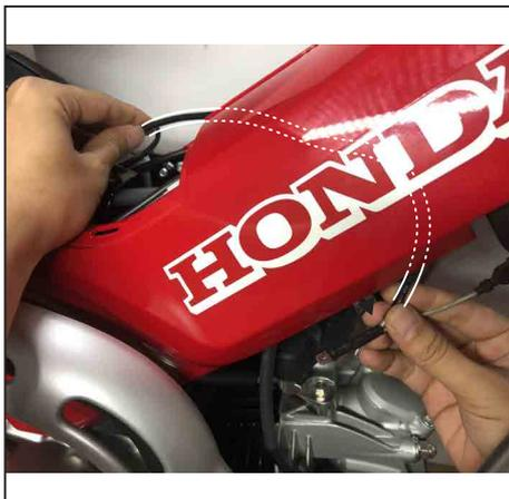
右メインパイプカバーの隙間から、イグニッションコイルまで、④IGコイル分岐コードを通します。
