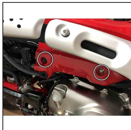
右メインパイプカバーのクランクケース上の2本のスクリーを外します。
