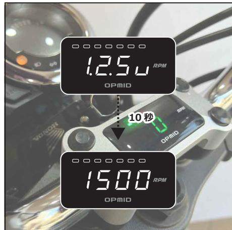
キーを回すと、まず電圧計を表示してからタコメーターに切り替わります。
