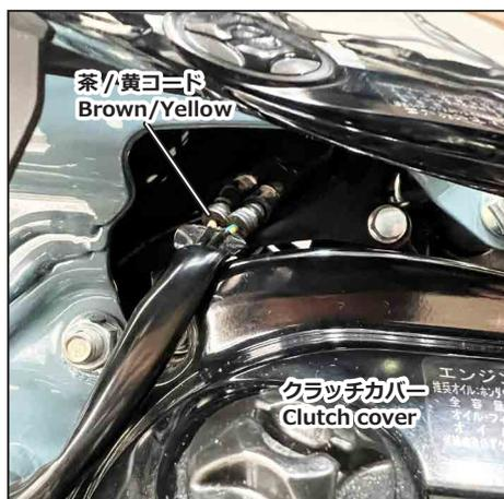
クラッチカバーの上にあるリアブレーキスイッチ接続端子の茶/黄コードから12V電源を取り出します。3本のボルトを外し、サイレンサーを取り外すと作業が行い易くなります。
