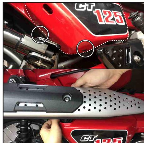
スクリー1本と、トリムクリップ（長）1本を外し、右ボディカバーを外します。
