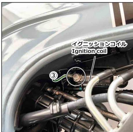
イグニッションコイルの固定ボルトに③アースコードを共締めする。
