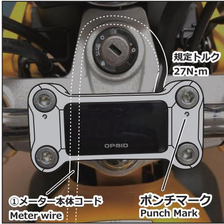
アッパーホルダーのポンチマークをフロント側に向け、純正キャップ4個、純正ソケットボルト4本を再利用して取り付け。ポンチマーク側のボルトから締め付ける。キーシリンダーの前方にコードを回し、メインハーネスに沿わせる。
