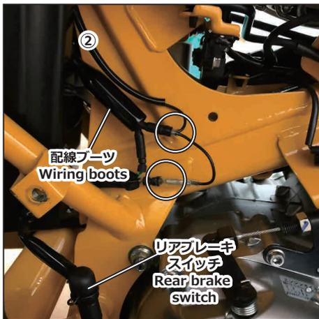
配線ブーツを上にはずらし②電源コードをリアブレーキスイッチの黒コードの接続端子間に割り込ませる。
