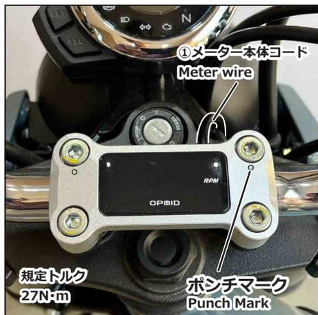
アッパーホルダーのポンチマークをフロント側に向け、純正キャップ 4 個、純正ソケットボルト 4 本を再利用して取り付け。ポンチマーク側のボルトから締め付ける。
