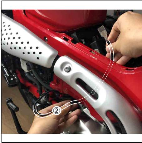
フレームとの隙間を少し広げて、右メインパイプカバーの内側から②電源コードを通します。
