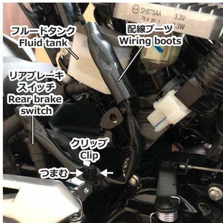
リアブレーキスイッチコードのクリップを外し、フルードタンクの裏から配線ブーツごと引っ張り出す。
